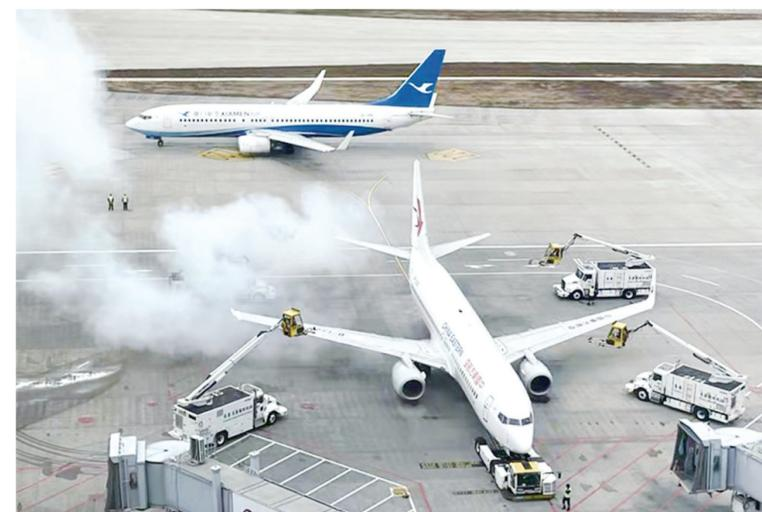
长春机场使用特种车除冰车为飞机表面除冰/长春机场供图
