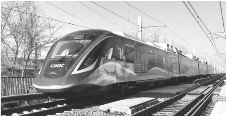
图为我国首列氢能源市域列车在位于吉林省长春市的中车长客试验线进行运行试验。(中车长客股份公司供图)
