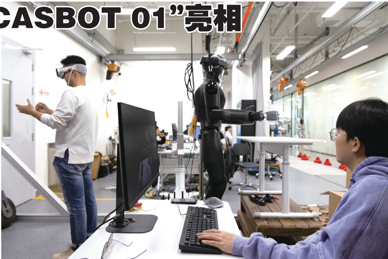
11月13日晚,人形机器人“CASBOT 01”在北京通过线上直播向公众发布。“CASBOT 01”昵称“星期三”,身高约1.79米,体重60公斤,整机拥有52个自由度,作业续航时间超过4小时。发布这款机器人的灵宝CASBOT是一家专注于通用型人形机器人与具身智能领域的创新型企业,团队核心人员来源于中国科学院自动化研究所、清华大学、北京理工大学等高校和研究机构。
