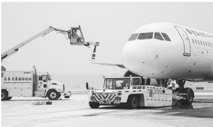
除冰车保障作业 吉林机场集团供图
